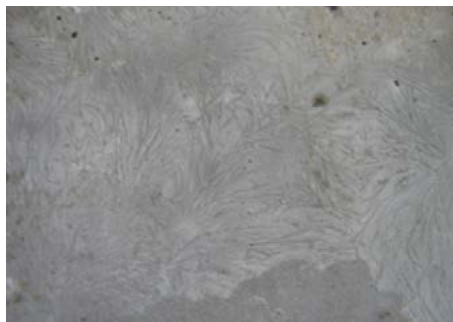
Zdjęcie 2. Zarysowania wywołane przemarzaniem na powierzchni świeżego betonu
