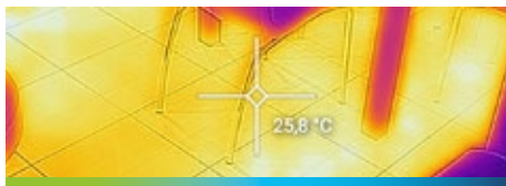
Rys.2. Zdjęcie po wykonaniu podkładu podłogowego z zastosowaniem iX CPP20 wykonane kamerą termowizyjną FLIR T640 przez firmę WERBA Waldemar Werbicki (17.03.2021).
