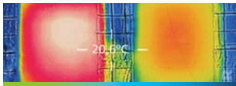
Rys.1. Zdjęcie podkładu podłogowego w trakcie wygrzewania wykonane kamerą termowizyjną FLIR T640. Po prawej jastrych cementowy, po lewej – podkład na bazie iX CPP20.
