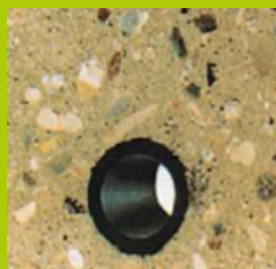
Agilia Sols A Element ogrzewania podłogowego zatopiony w mieszance Agilia Sols A
