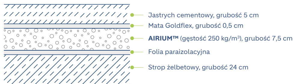
Rys. 1. Przekrój przez badane stropy
