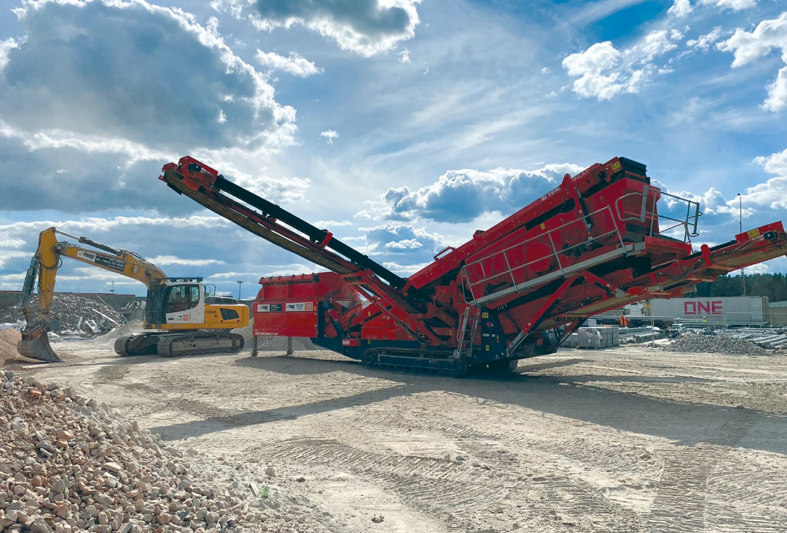
Przesiewacz do frakcjonowania kruszyw podczas produkcji
