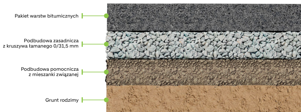
Rysunek 3. Przekrój konstrukcji drogowej nawierzchni podatnej/półsztywnej
