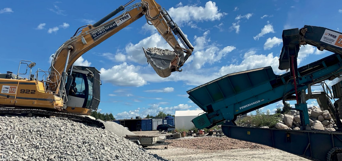
Przesiewanie kruszywy na odpowiednie frakcje
