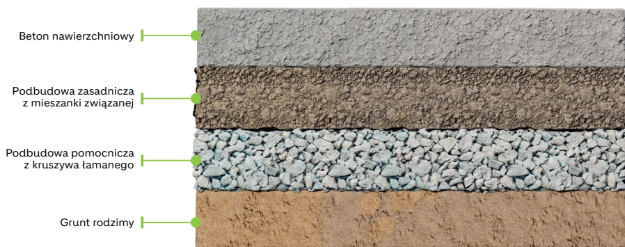
Rysunek 4. Przekrój konstrukcji drogowej nawierzchni sztywnej
