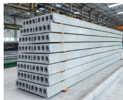
Fot. 7. Sprężone płyty kanałowe HC ułożone w sztaplu
